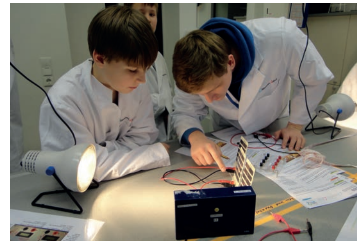
Schüler experimentieren mit Solarzellen und lernen Einstrahlwinkel, Wirkungsgrad und Reihenschaltung kennen.
